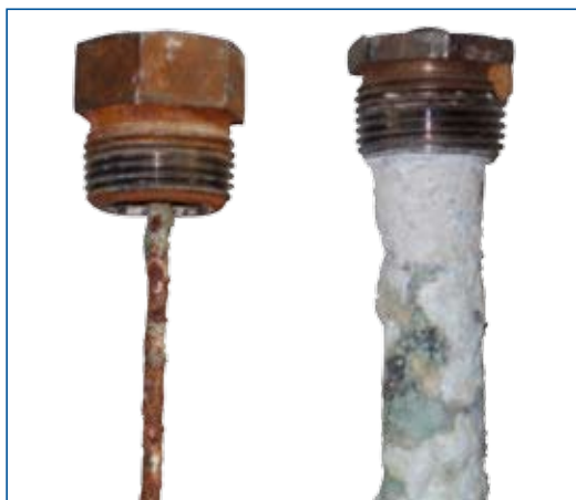
Onderhoud en/of vervanging van de magnesium anodes schiet er helaas vaak bij in. De gevolgen? Lekkende, onherstelbare boiler tanks, overlast, hoge kosten!
